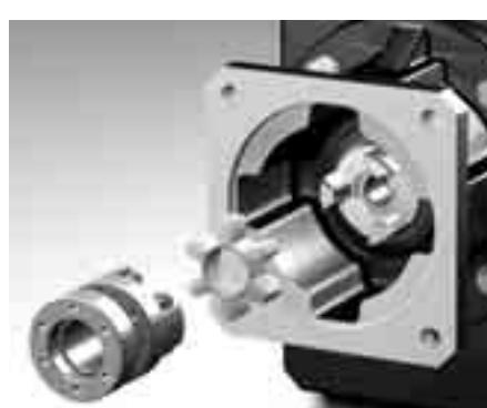
SMS Motoradapter MQ (bis Adaptergröße MQ50) mit spielfreier Steckkupplung zum Anbau von Servomotoren mit glatter Welle
