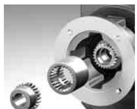
MGS Motoradapter MR mit Bogenzahnkupplung (flexible Wellenverbindung) für Motoren mit Passfeder, optional auch mit spielfreier Steckkupplung zum Anbau von Motoren mit glatter Welle
